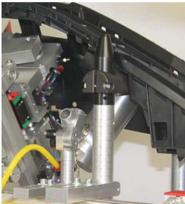
GAS-MK - Greiffinger Anschlagstück multikompatibel (Eine Seite ist flach und die andere rund ausgeformt)
